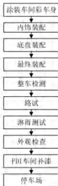
图 2.6-4 总装厂房生产工艺流程图
